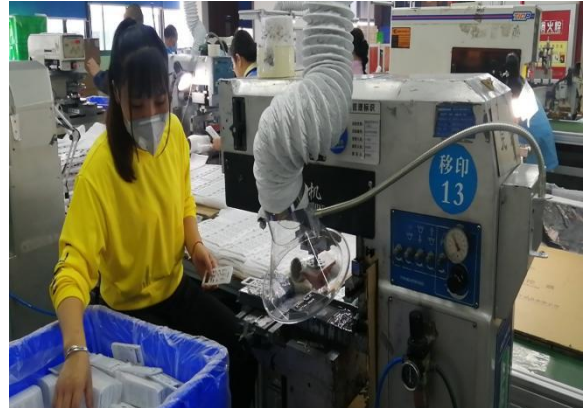
移印设备工位处集气管
