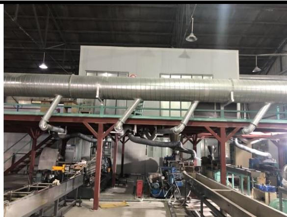
挤出线集气罩+封闭混合机
