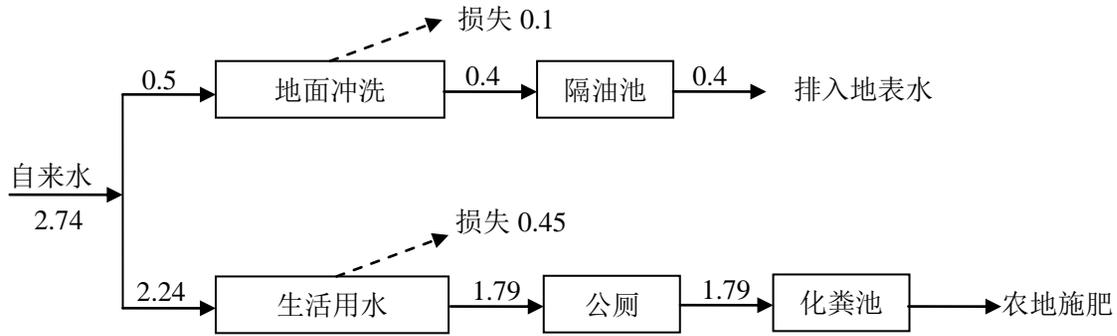
图 2-1 项目水平衡图 (单位:  $\text{m}^3/\text{d}$ )
